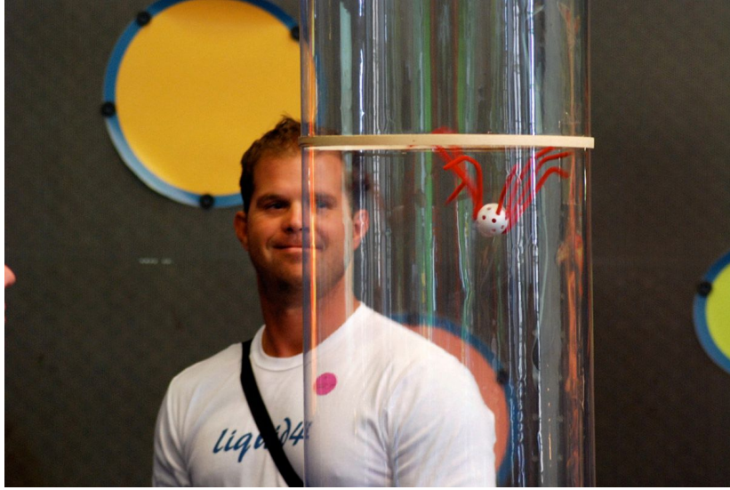
الشكل 2: كرة بلاستيكية خفيفة بأرجل شبيهة بأرجل العنكبوت تحوم في أنبوب الزجاج.
